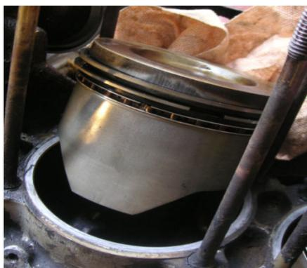
**Gambar 1.** Posisi pemasangan ring piston (www.avanzaxenia.net, 2010)
