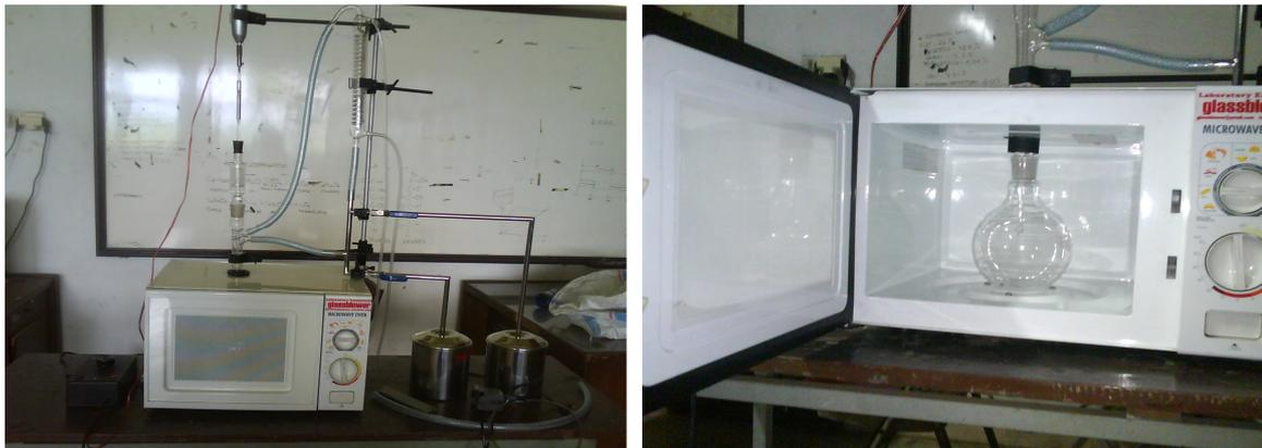
**Gambar 1. Foto alat ekstraktor gelombang mikro**
