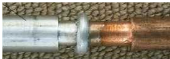
Gambar 8. Sambungan Cu dan Al
