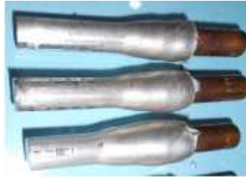
Gambar 14. Sambungan AL-CU dengan proses las gesekan
