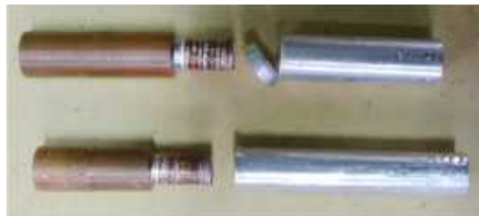
Gambar 16. Bahan yang telah di uji tarik
