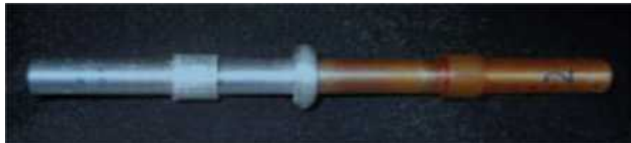
Gambar 6. Sambungan las gesek Al dan Cu
