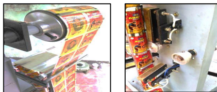
Gambar 3.5. Cara kerja mesin sachet pada paking plastic/aluminium foil
