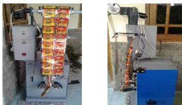
Gambar 3.4 Mesin sachet dilengkapi mekanik pemanasan, pemutaran dan pemotongan(feeder ke filler)
