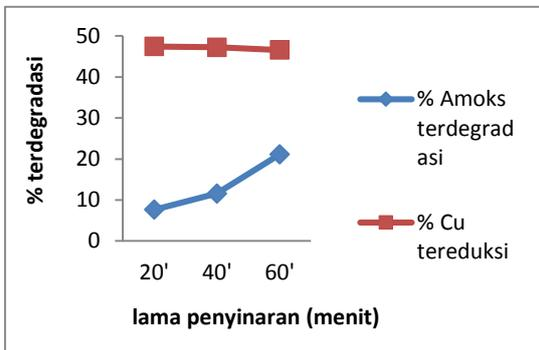
Gambar 3. Pengaruh lama penyinaran katalis  $TiO_2$  terhadap fotodegradasi amoksisilin dan fotoreduksi ion logam  $Cu(II)$
