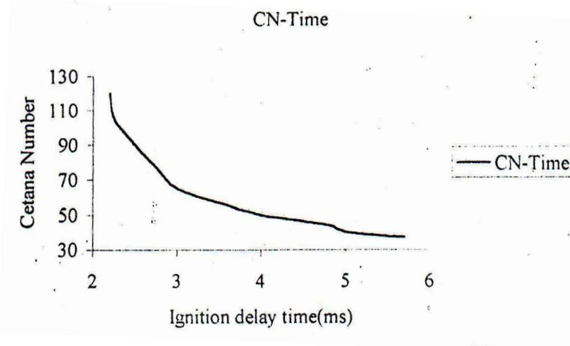
Gambar 4 : Hubungan Antara Angka Setana Dengan Kecepatan Penyalaan
