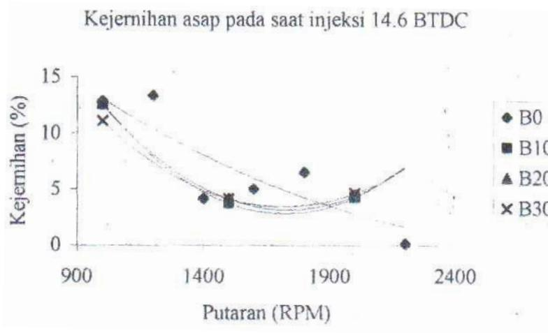
Gambar 11. Grafik Hubungan Kejernihan Asap-Rpm Dengan Berbagai Variasi Saat Injeksi
