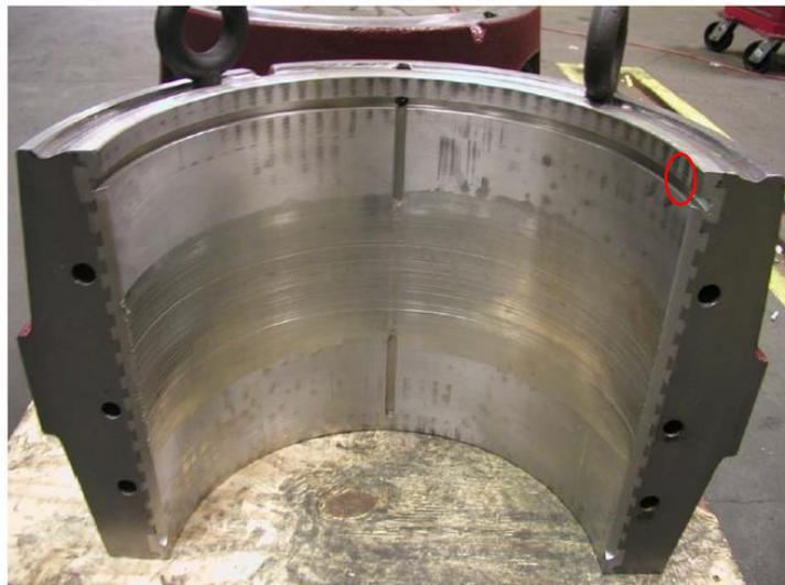
Gambar 3. RSB yang diperkuat bonding *shell* dan *babbitt* dengan groove (Baranagan, 2015)
