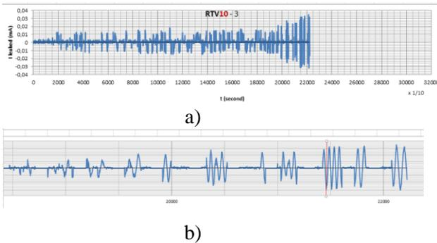
**Gambar 7** a) Hasil pengujian arus bocor komposit resin epoksi RTV10 sampel 3. b) Hasil pembesaran 10x *range* saat sebelum *breakdown*
