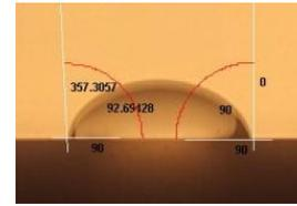
**Gambar 3.** Penghitungan sudut kontak sampel
