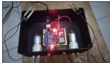
Gambar 3. Alat Memonitoring Kelembaban Tanah Aktif
