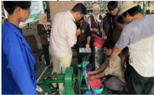
Gambar 7. Proses Penepungan dengan Disc Mill
