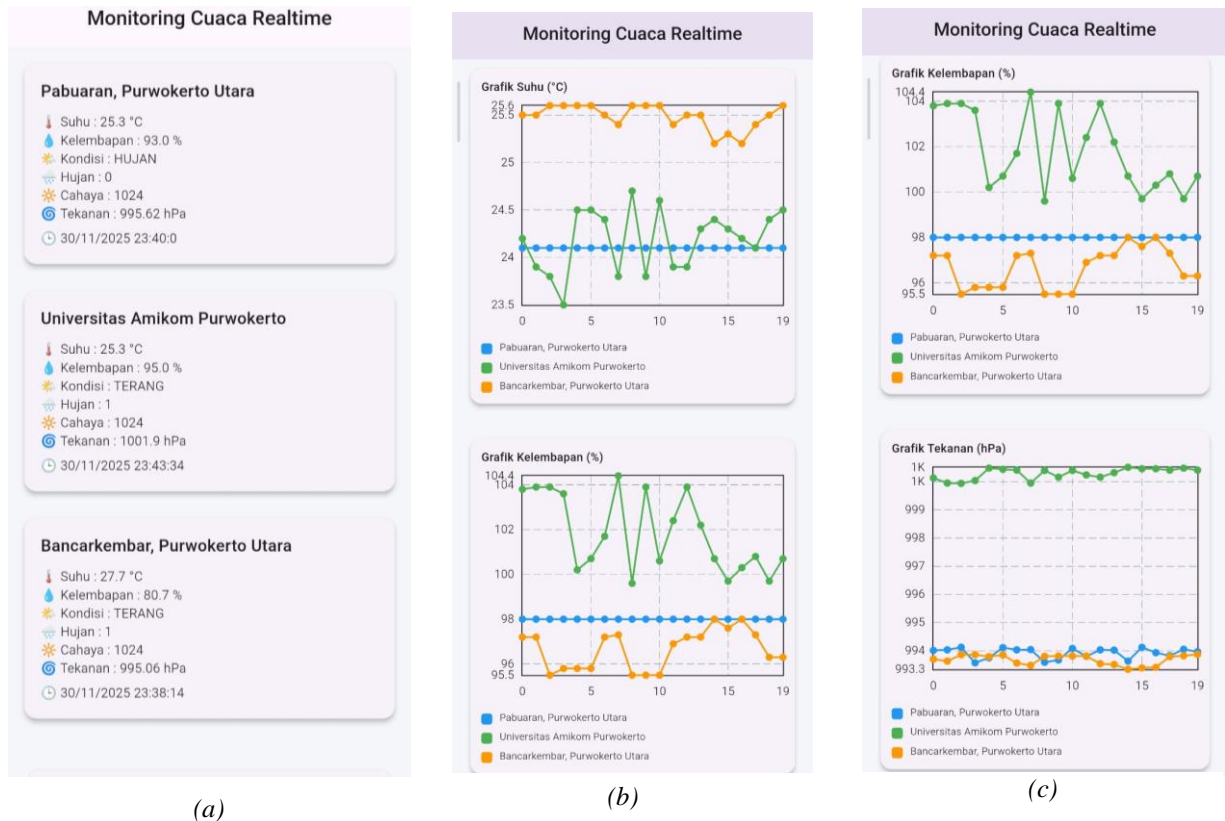
Gambar 5. Tampilan Mobile Aplikasi Monitoring Cuaca: (a) Ringkasan Data; (b) Grafik Suhu dan Kelembapan; (c) Grafik Kelembapan dan Tekanan
